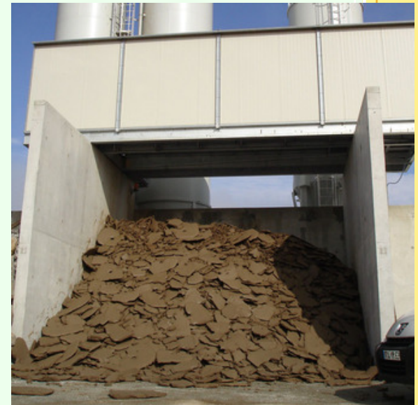
Exemple d'outils de valorisation des argiles : filtre presse
