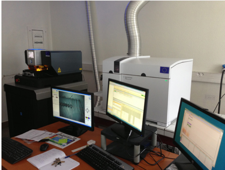
Système rennais : Laser Excimer ESI NWR193UC ICP-MS quadripole 7700x
